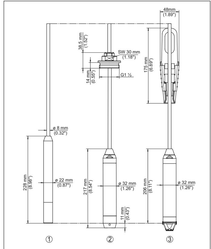
Fig. 46: Dimensions VEGABAR
