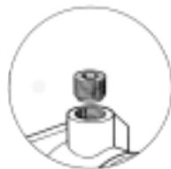
Encoche pour le blocage de la vis d'arrêt en rotation
